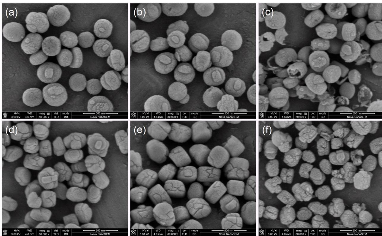
**Fig. S1** SEM images of (a) T-HZ, (b) T-HZ-0.1AT, (c) T-HZ-0.2AT, (d) S-HZ, (e) S-HZ-0.1AT, and (f) S-HZ-0.2AT.
