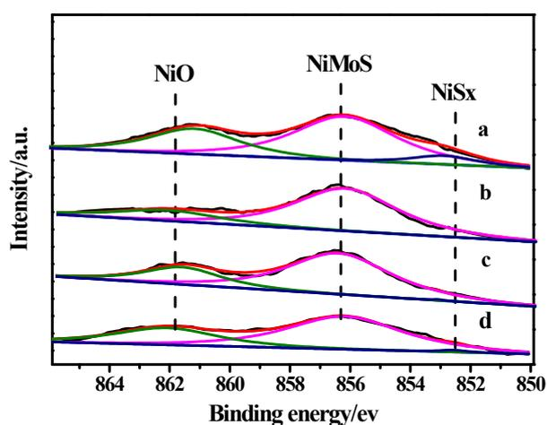
**Figure S6.** Ni2p XPS Spectra of the sulfided catalysts: (a) NiMo/ZSM-5, (b) NiMo/Zk-3, (c) NiMo/Zk-4, (d) NiMo/KIT-5.
