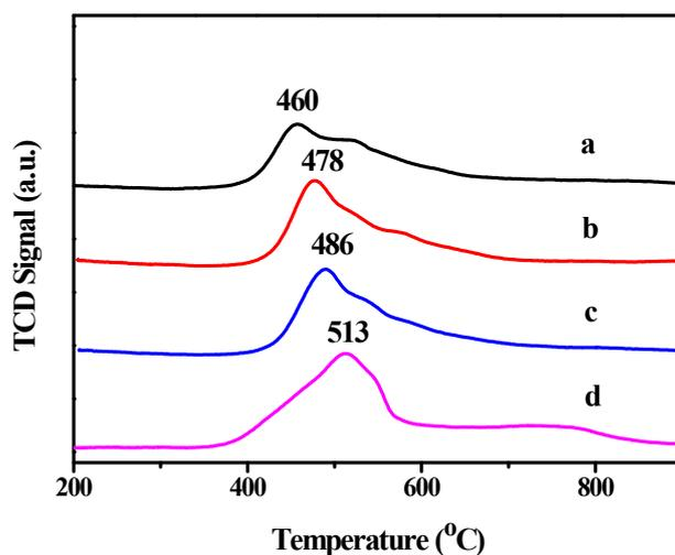
**Figure S5.** H<sub>2</sub>-TPR of various catalysts: (a) NiMo/KIT-5, (b) NiMo/Zk-3, (c) NiMo/Zk-4. (d) NiMo/ZSM-5.
