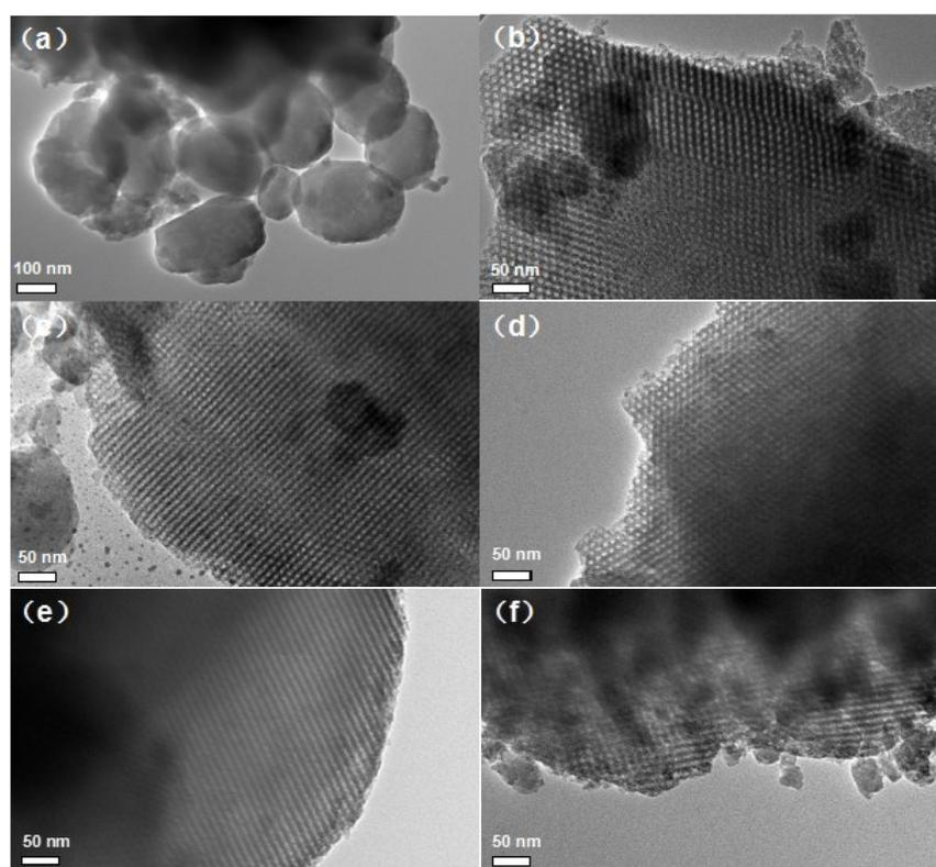
**Figure S1.** TEM images of the calcined supports: (a) ZSM-5, (b) KIT-5, (c) Zk-2, (d) Zk-3, (e) Zk-4, (f) Zk-6
