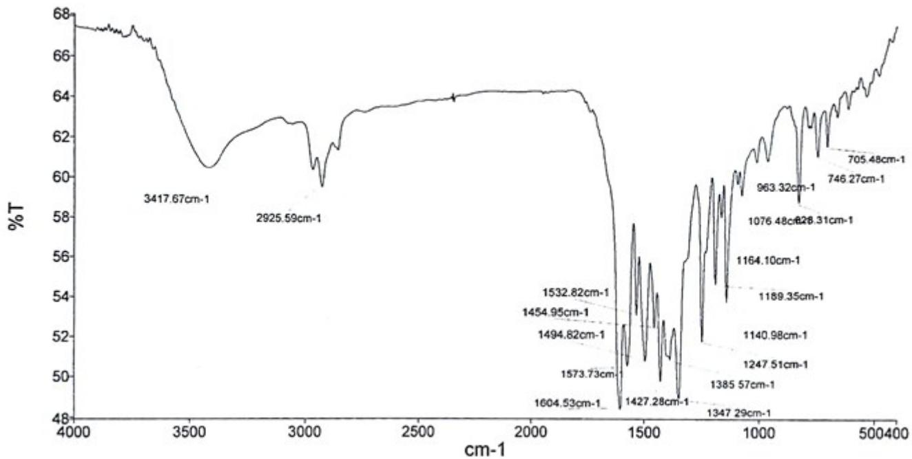
**Fig. S17:** FTIR spectra of NDEA+Cu<sup>2+</sup>.
