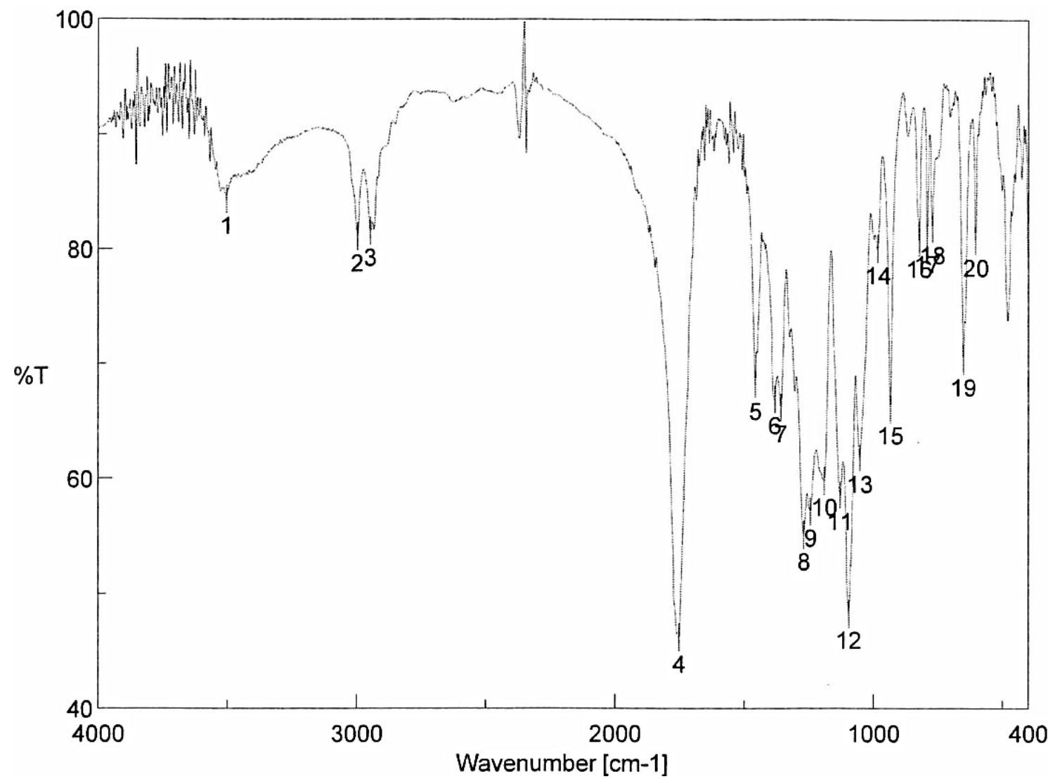
**Fig. S27** IR spectrum of poly(2a).
