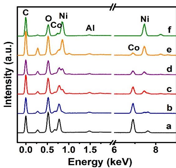
Fig.S6 EDX analysis of (a)  $\text{Co}_3\text{O}_4$ , (b)  $\text{Co}_6\text{-Ni}_1\text{-O}$ , (c)  $\text{Co}_2\text{-Ni}_1\text{-O}$  (d)  $\text{Co}_1\text{-Ni}_1\text{-O}$  (e)  $\text{Co}_1\text{-Ni}_6\text{-O}$  and (f)  $\text{NiO}$ .
