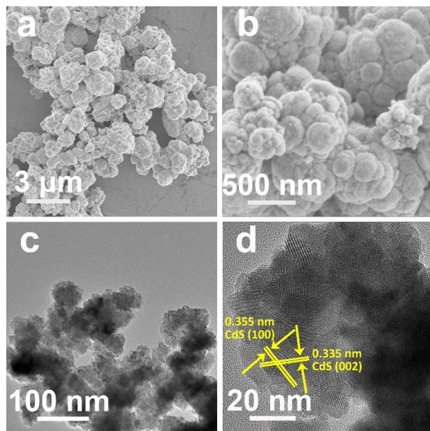
**Figure S6.** (a, b) SEM, (c) TEM and (d) HRTEM images of CdS nanoparticle aggregates.
