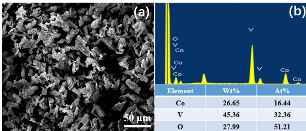
**Fig. S6** EDS spectrum of  $\text{CoV}_2\text{O}_6 \cdot 4\text{H}_2\text{O}$
