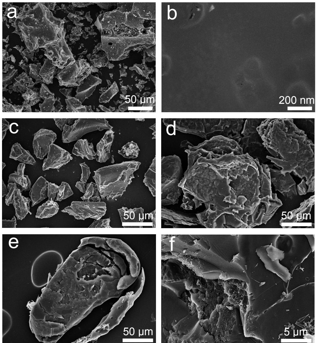
**Fig. S1** SEM images of (a) (b) PC, (c) HFJDAC-500, (d) HFJDAC-600, (e) HFJDAC-700, and (f) HFJDAC-800.
