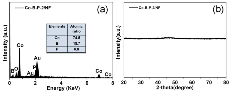
**Fig. S2** (a) EDS spectrum and elemental composition (inset) of Co-B-P-2/NF. (d) XRD pattern of Co-B-P-2/NF.
