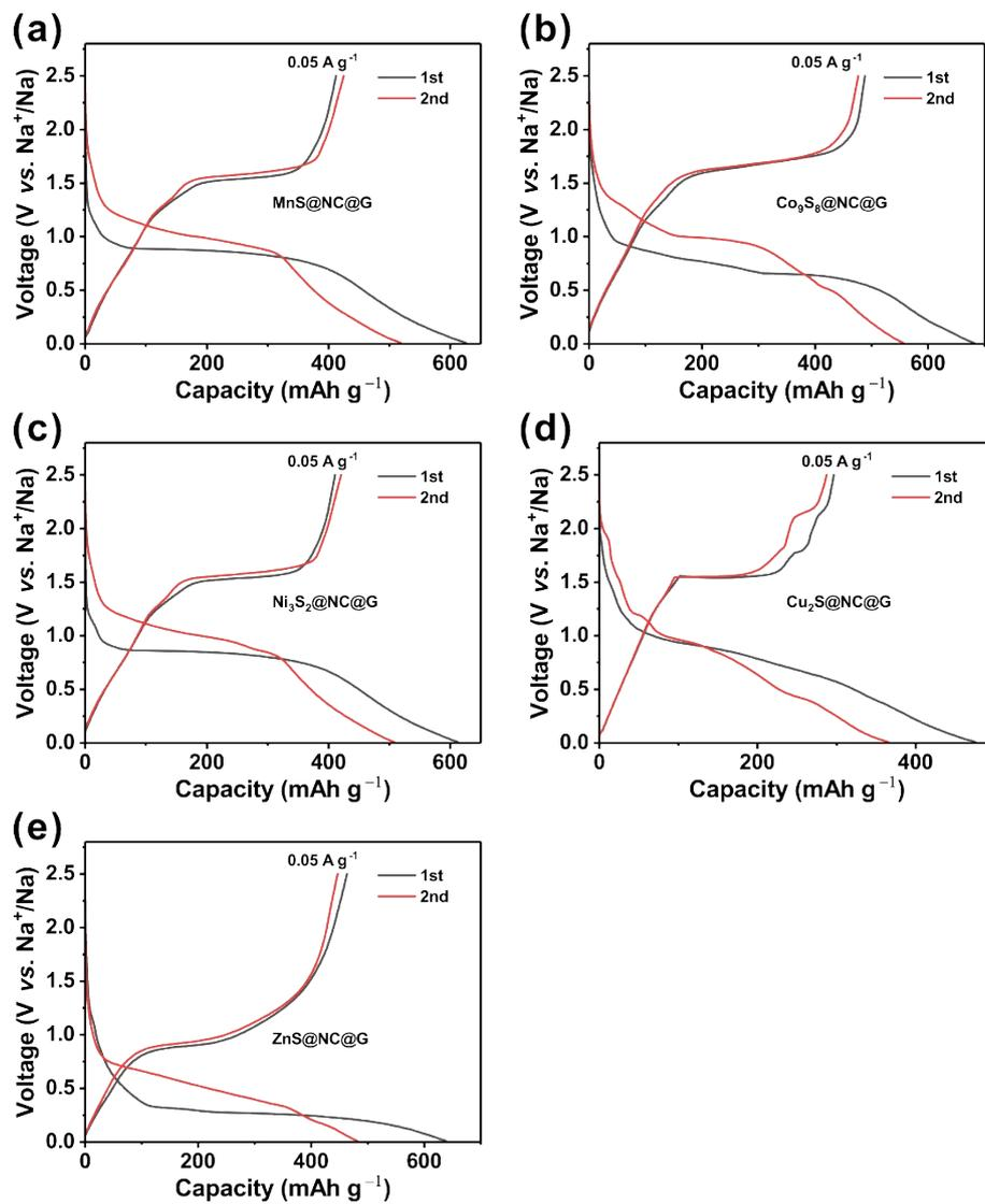
**Figure S12** The initial two discharge/charge profiles of (a)  $\text{MnS@NC@G}$ , (b)  $\text{Co}_9\text{S}_8@NC@G$ , (c)  $\text{Ni}_3\text{S}_2@NC@G$ , (d)  $\text{Cu}_2\text{S@NC@G}$ , and (e)  $\text{ZnS@NC@G}$ .
