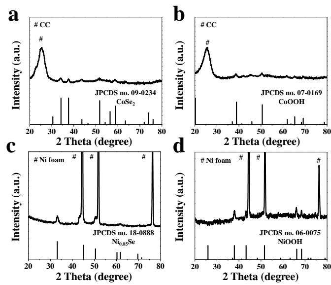
**Figure S4** XRD patterns of (a) CoSe<sub>2</sub>@CC, (b) E-CoSe<sub>2</sub>@CC, (c) Ni<sub>0.85</sub>Se@NF and (d) E-Ni<sub>0.85</sub>Se@NF.
