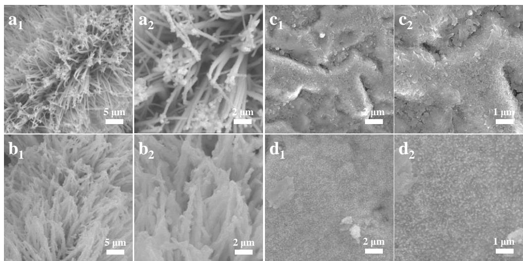
**Figure S3** SEM images of (a) CoSe<sub>2</sub>@CC, (b) E-CoSe<sub>2</sub>@CC, (c) Ni<sub>0.85</sub>Se@NF and (d) E-Ni<sub>0.85</sub>Se@NF.
