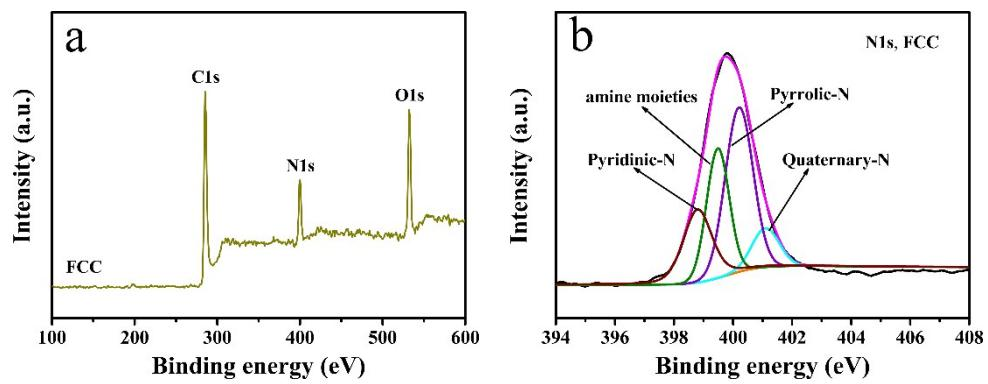
**Fig. S10.** (a) XPS survey and (d) N1s core-level spectra of FCC.
