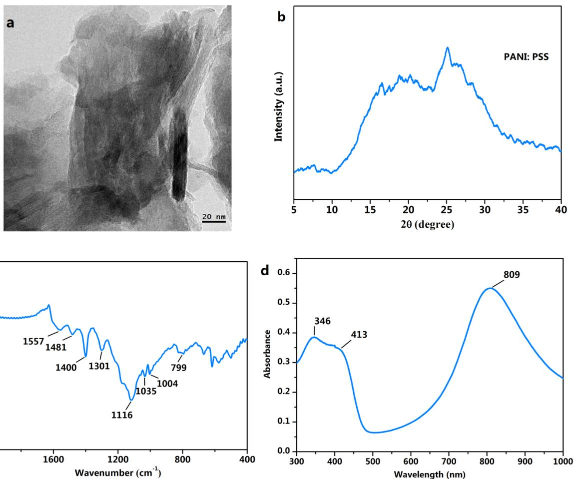
Figure S2. (a) TEM image, (b) XRD pattern, (c) FTIR spectra and (d) UV-vis absorption spectra of PANI: PSS.
