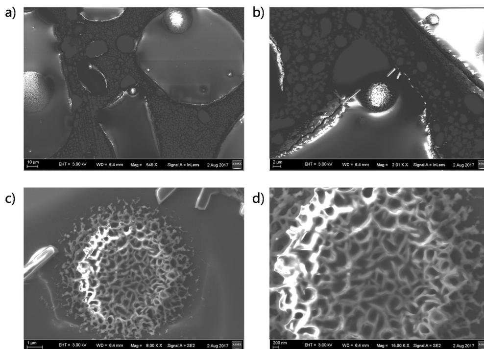
**Fig. S6** SEM micrographs of a dried film of the PVP/ $\text{CH}_2\text{Cl}_2$  gel in length scales of (a) 10  $\mu\text{m}$ ; (b) 2  $\mu\text{m}$ ; (c) 1  $\mu\text{m}$  and (d) 200 nm.
