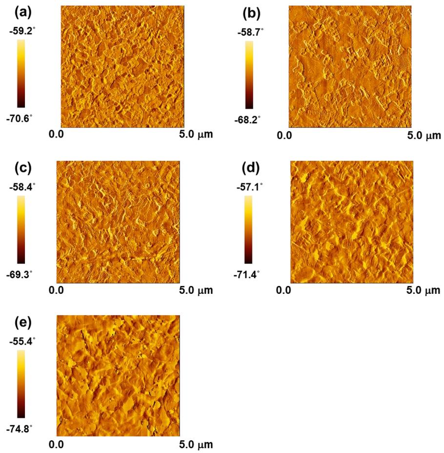
**Figure S3** Phase images (size:  $5 \mu\text{m} \times 5 \mu\text{m}$ ) of (a) 3.9, (b) 12.7, (c) 33.4, (d) 57.0, and (e) 116.3 nm  $\text{CH}_3\text{NH}_3\text{PbI}_{3-x}\text{Cl}_x$  films.
