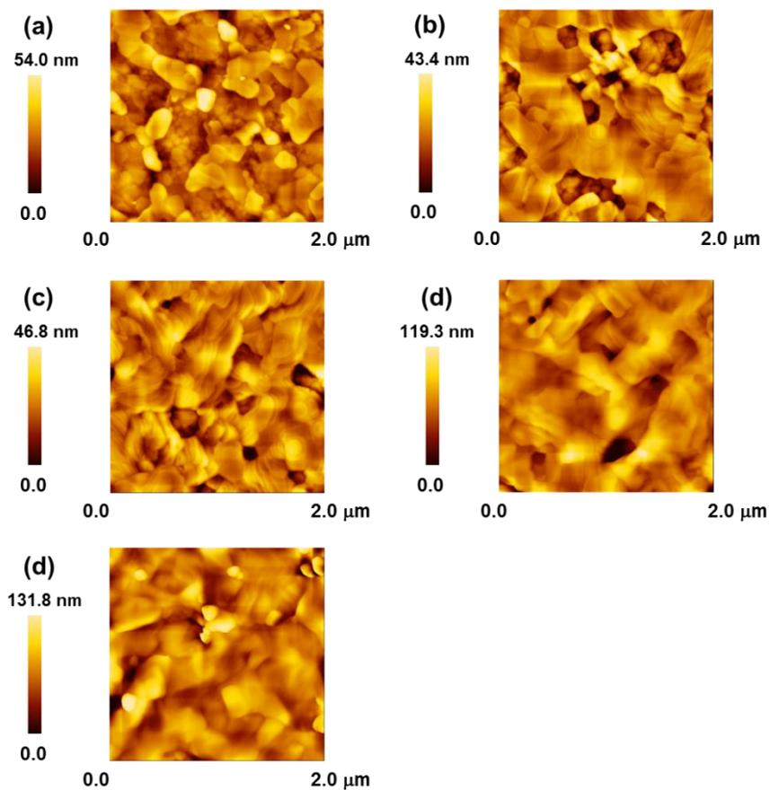
**Figure S2.** Topographic images (size: 2 μm × 2 μm) of (a) 3.9, (b) 12.7, (c) 33.4, (d) 57.0, and (e) 116.3 nm  $\text{CH}_3\text{NH}_3\text{PbI}_{3-x}\text{Cl}_x$  films.
