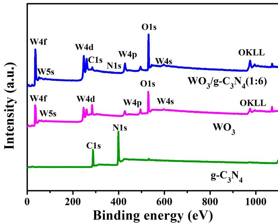
**Fig. S3** XPS survey of  $\text{WO}_3/\text{g-C}_3\text{N}_4(1:6)$ ,  $\text{WO}_3$  and  $\text{g-C}_3\text{N}_4$ .
