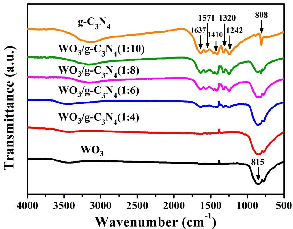
**Fig. S2** FT-IR spectrum of  $\text{WO}_3/\text{g-C}_3\text{N}_4$ ,  $\text{WO}_3$  and  $\text{g-C}_3\text{N}_4$ .
