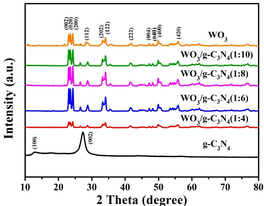
**Fig. S1** XRD patterns of  $\text{WO}_3/\text{g-C}_3\text{N}_4$ ,  $\text{WO}_3$  and  $\text{g-C}_3\text{N}_4$ .
