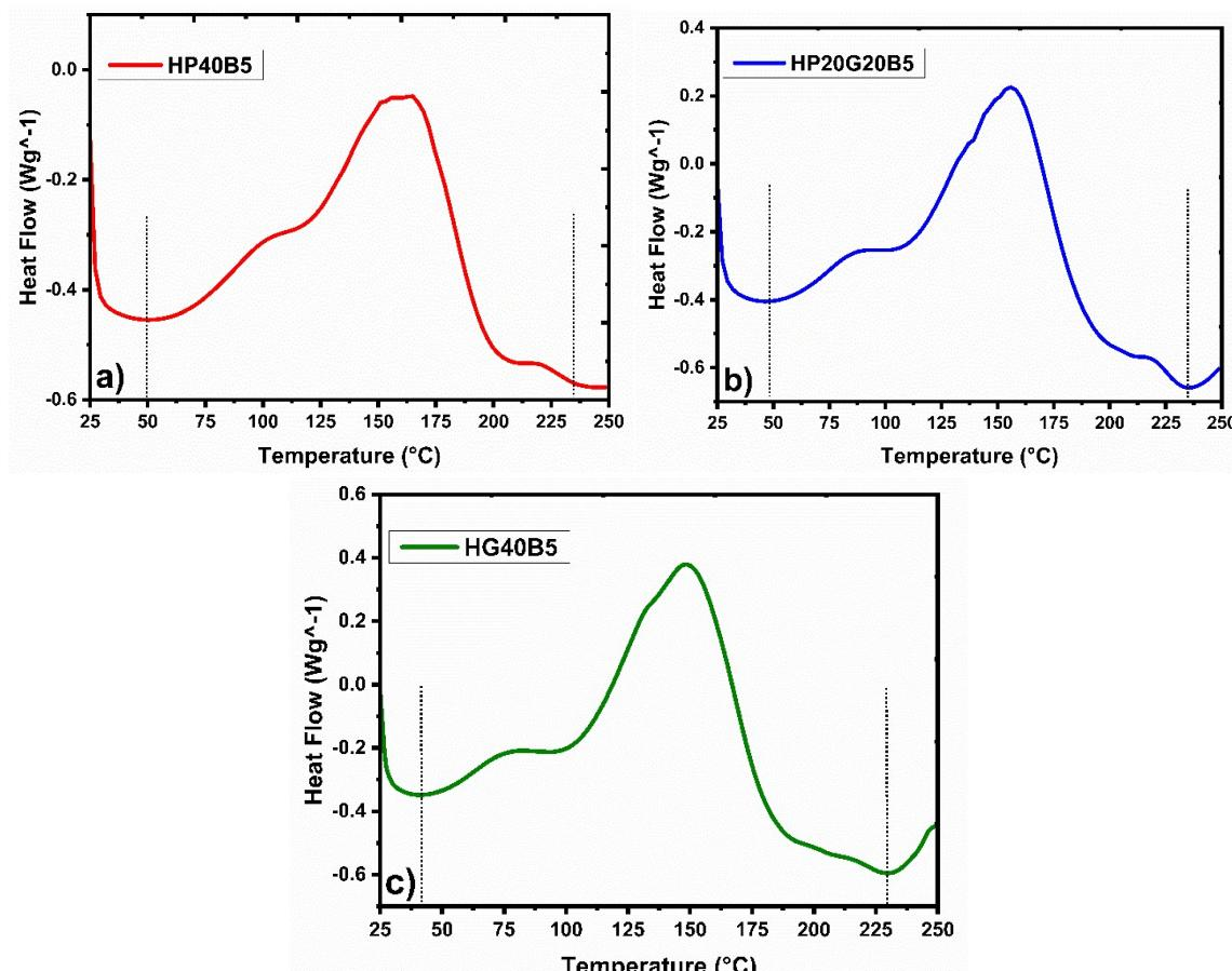
**Figure S1.** DSC analyses for uncured mixtures: a) 55 % H- 40 % PEGDE- 5 % BDMA, b) 55% H- 20 % PEGDE- 20 % GDE- 5 % BDMA, c) 55 % H- 40 % GDE- 5 % BDMA
