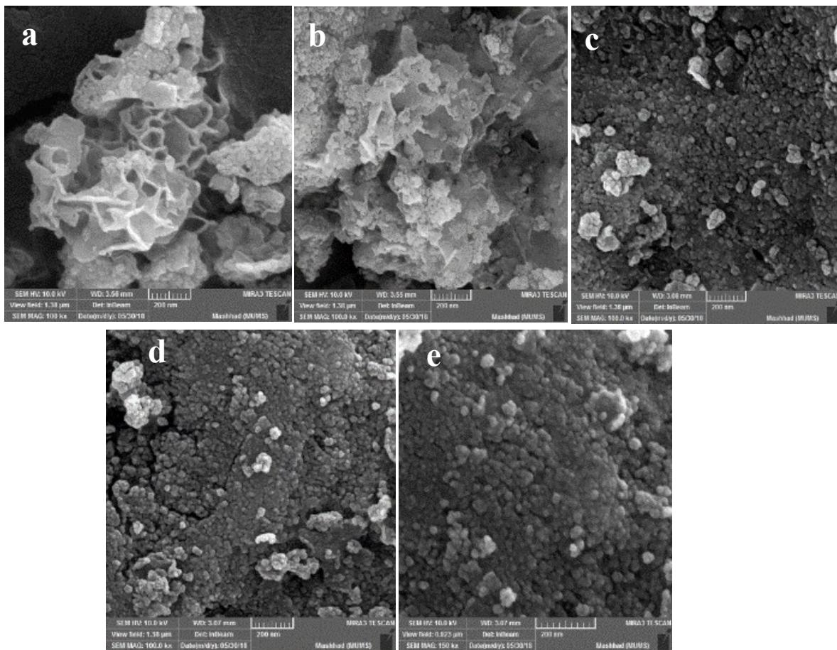
**Fig. S5.** FE-SEM images of  $\text{Fe}_3\text{O}_4@\text{AMCA-MIL53}(\text{Al})-\text{NH}_2\text{-Co}^{\text{II}}$  NPs(**VI**) (a-c), the 7<sup>th</sup> reused  $\text{Fe}_3\text{O}_4@\text{AMCA-MIL53}(\text{Al})-\text{NH}_2\text{-Co}^{\text{II}}$  NPs (**VI**) from the C-N cross coupling reaction (d) and the 7<sup>th</sup> reused  $\text{Fe}_3\text{O}_4@\text{AMCA-MIL53}(\text{Al})-\text{NH}_2\text{-Co}^{\text{II}}$  NPs (**VI**) from the C-S cross coupling reaction (e).
