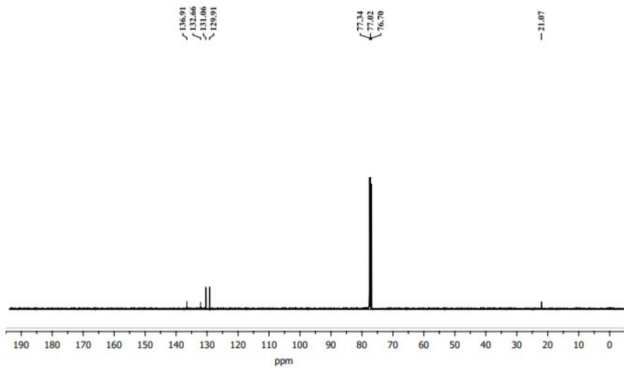
**Figure 51:** <sup>13</sup>C NMR (75 MHz, CDCl<sub>3</sub>) of Di-(*p*-tolyl) sulfane (**20b**)
