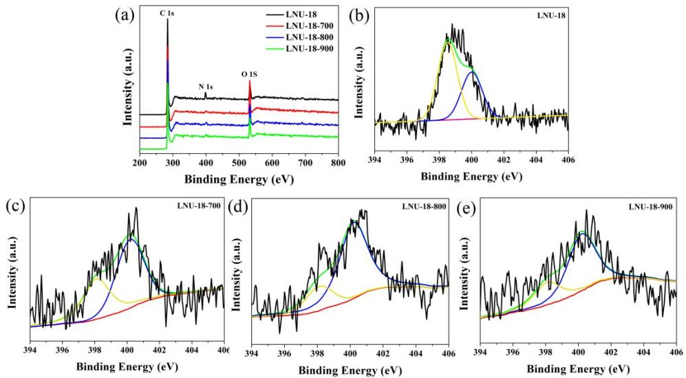
**Fig. S7** (a) XPS spectra for LNU materials; N 1s XPS for (b) LNU-18, (c) LNU-18-700, (d) LNU-18-800, and (e) LNU-18-900.
