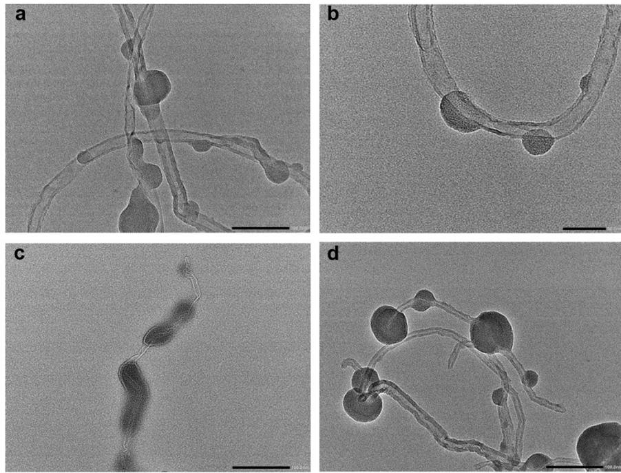
**Fig. S12.** The TEM images of (a)  $\text{PW}_{12}/\text{CNTs}$ , (b)  $\text{PMo}_{12}/\text{CNTs}$ , (c)  $\text{P}_2\text{W}_{18}/\text{CNTs}$  and (d)  $\text{P}_2\text{Mo}_{18}/\text{CNTs}$  nanocomposites.
