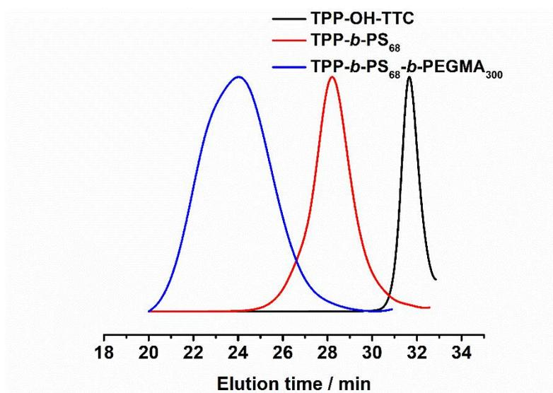
**Figure S5.** GPC trace of TPP-OH-TTC、TPP-*b*-PS<sub>68</sub>、TPP-*b*-PS<sub>68</sub>-*b*-PEGMA<sub>300</sub>.
