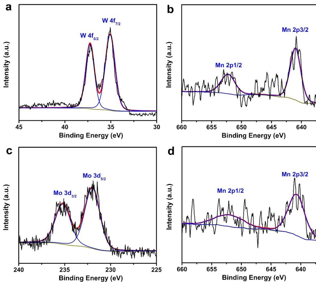
**Figure S12** the XPS spectra of  $PW_{12}\text{-MnL/KB}$ : (a) W, (b) Mn; the XPS spectra of  $PMo_{12}\text{-MnL/KB}$ : (c) Mo, (d) Mn.
