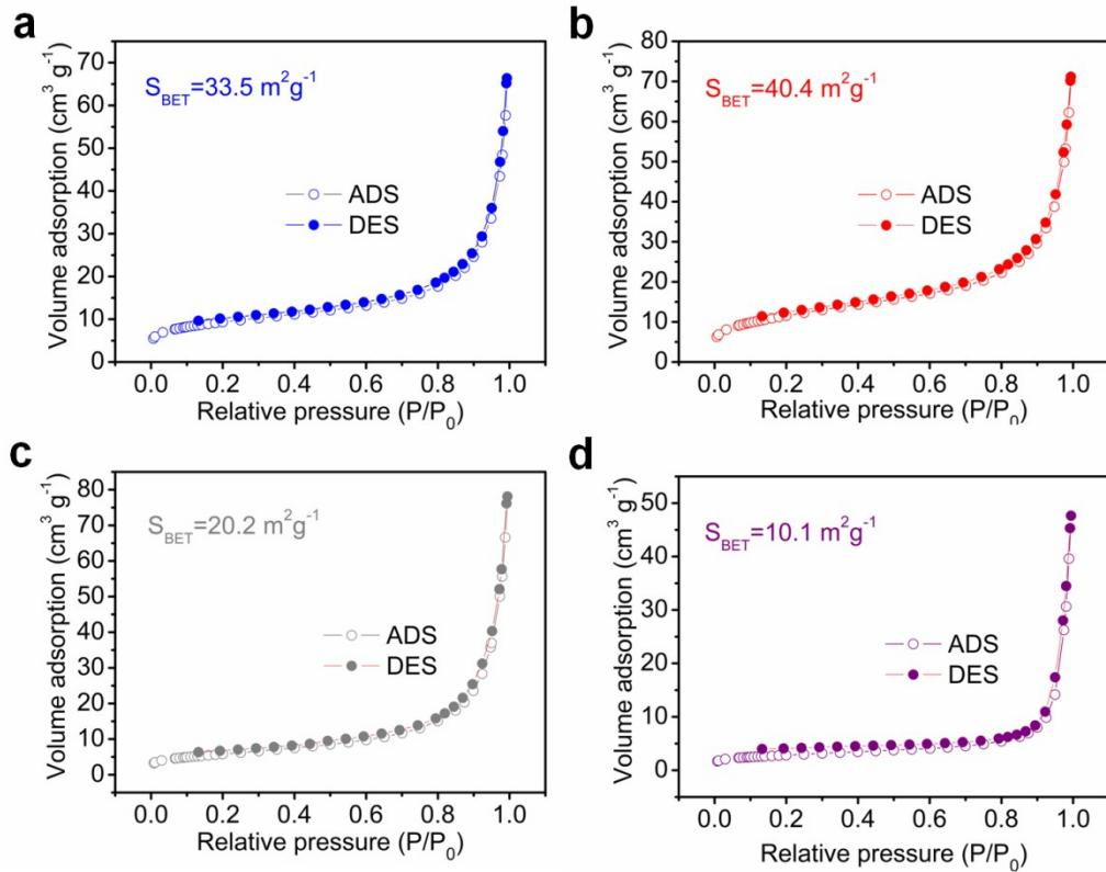
**Fig. S11.**  $\text{N}_2$  adsorption-desorption isotherm of (a)  $\text{RuS}_2\text{-400}$ , (b)  $\text{RuS}_2\text{-500}$ , (c)  $\text{RuS}_2\text{-600}$  and (d)  $\text{RuS}_2\text{-700}$ .
