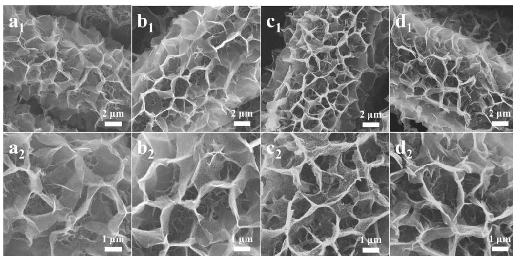
**Fig. S3** SEM images of (a) Ar-NiCoP|V-1, (b) Ar-NiCoP|V-2, (c) Ar-NiCoP|V-3 and (d) Ar-NiCoP|V-4.
