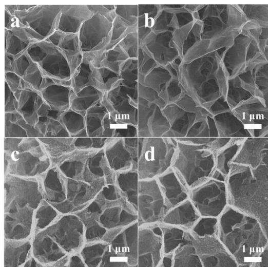
**Fig. S2** SEM images of (a) NiCoP, (b) Ar-NiCoP, (c) Ar-NiCoP|V and (d) T-NiCoP|V.
