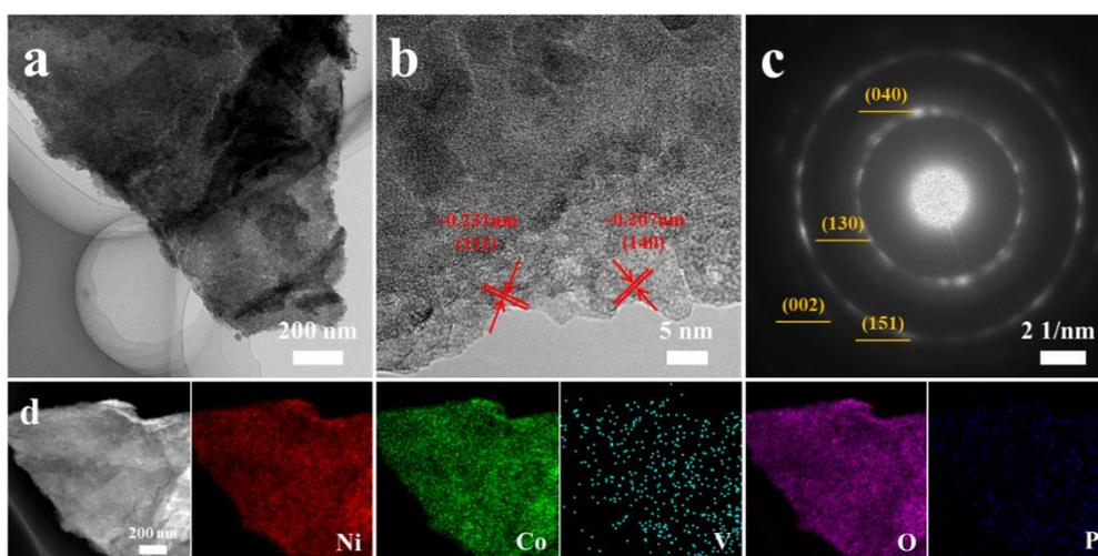
**Fig. S15** (a) TEM, (b) HRTEM, (c) SAED images and (d) corresponding element mappings
