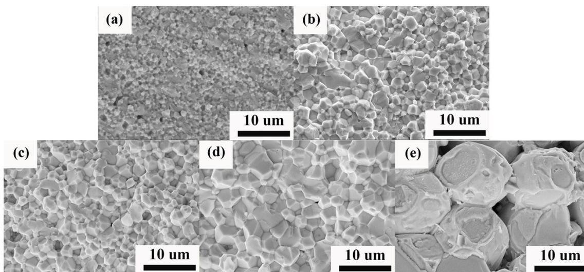
Fig. S6 SEM of BFO-BTO-LFO-Mn-1 ceramics sintered at (a)  $T=975^{\circ}\text{C}$ , (b)  $T=1000^{\circ}\text{C}$ , (c)  $T=1025^{\circ}\text{C}$ , (d)  $T=1050^{\circ}\text{C}$ , (e)  $T=1075^{\circ}\text{C}$ .
