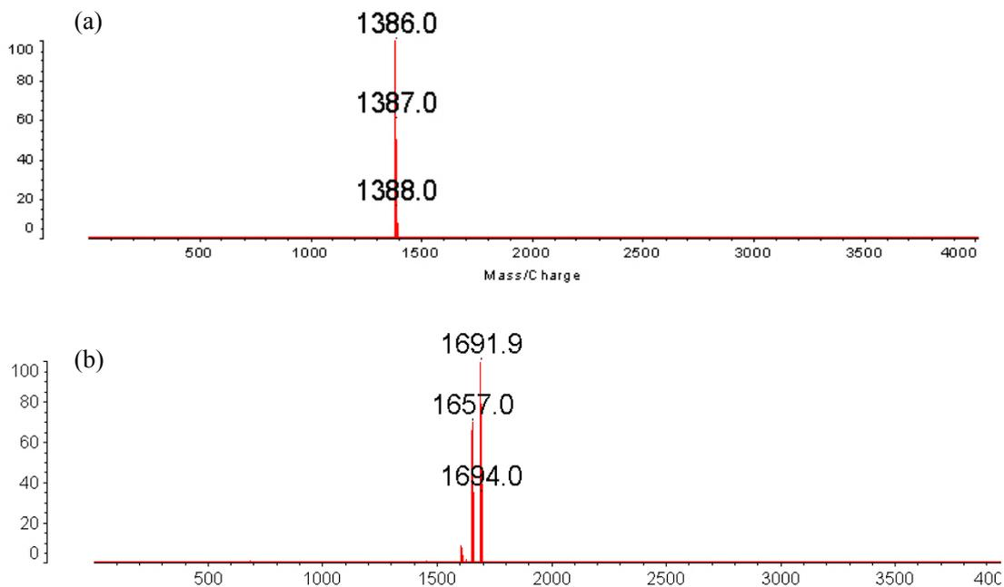
**Fig. S2.** MALDI-TOF mass spectra: a) bpy-DPA-TSB (**6**); b) bpy-DPA-TSB-Re (**7**).
