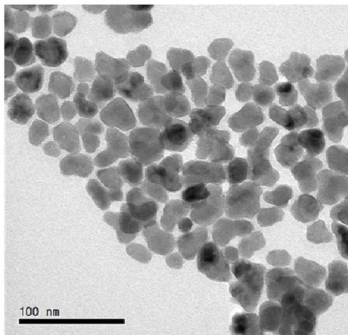
**Fig. S2** TEM image of colloidal NaYF<sub>4</sub>:Yb<sup>3+</sup>,Tm<sup>3+</sup> NPs.
