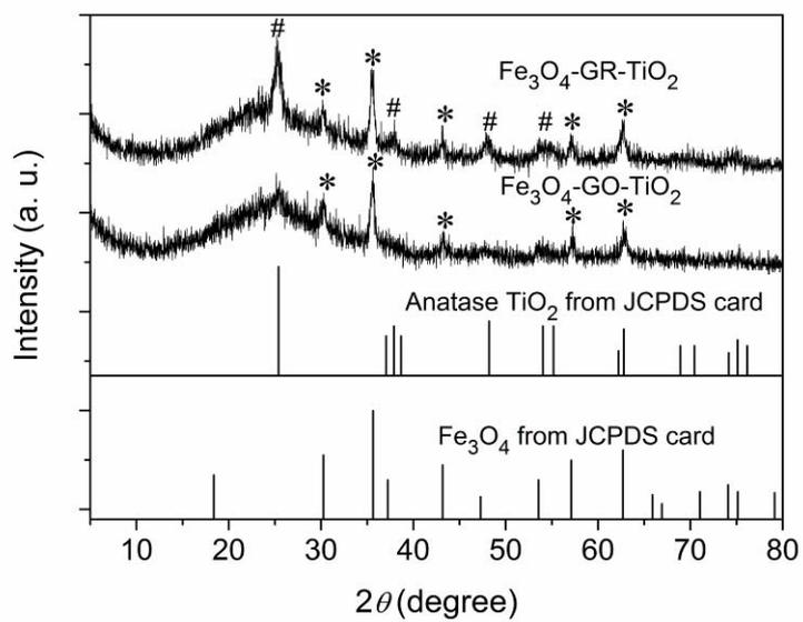
**Fig. S1** XRD pattern of  $\text{Fe}_3\text{O}_4\text{-GO-TiO}_2$  and  $\text{Fe}_3\text{O}_4\text{-GR-TiO}_2$ .
