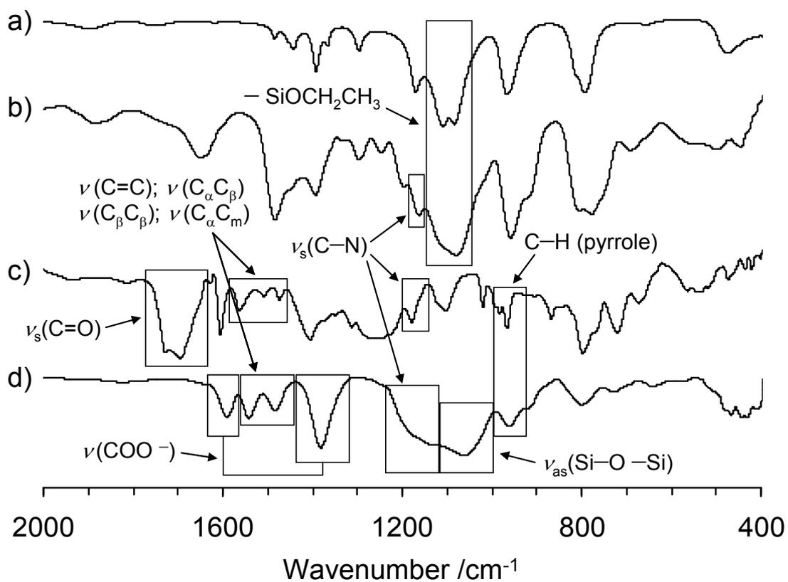
Figure S2. FTIR spectra of (a) TEOS, (b) TMAPS, (c) TCPP and (d) silica/TCPP HNTs.
