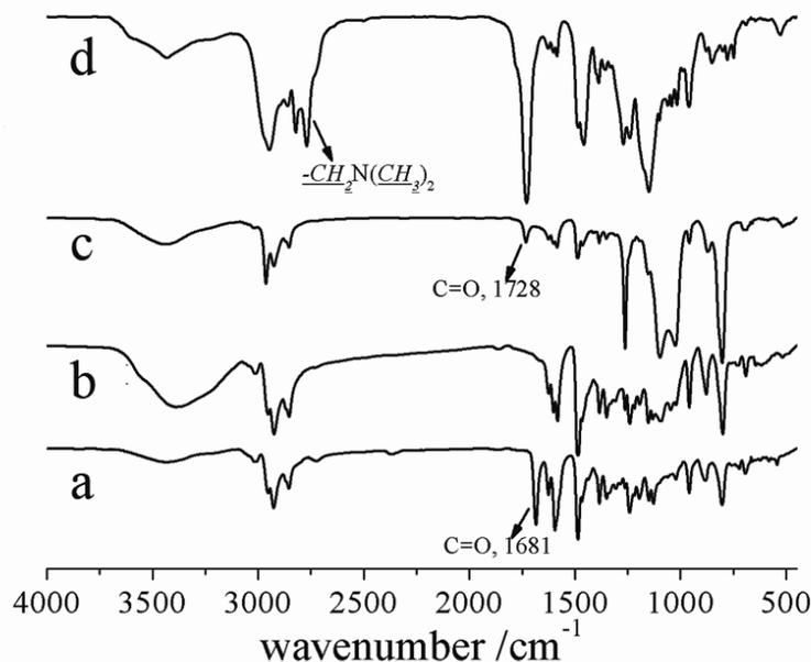
**Figure S2.** The FTIR spectra of: (a) HCP-CHO, (b) HCP-OH, (c) HCP-Br, (d) HCP-*star*-PDMAEMA.
