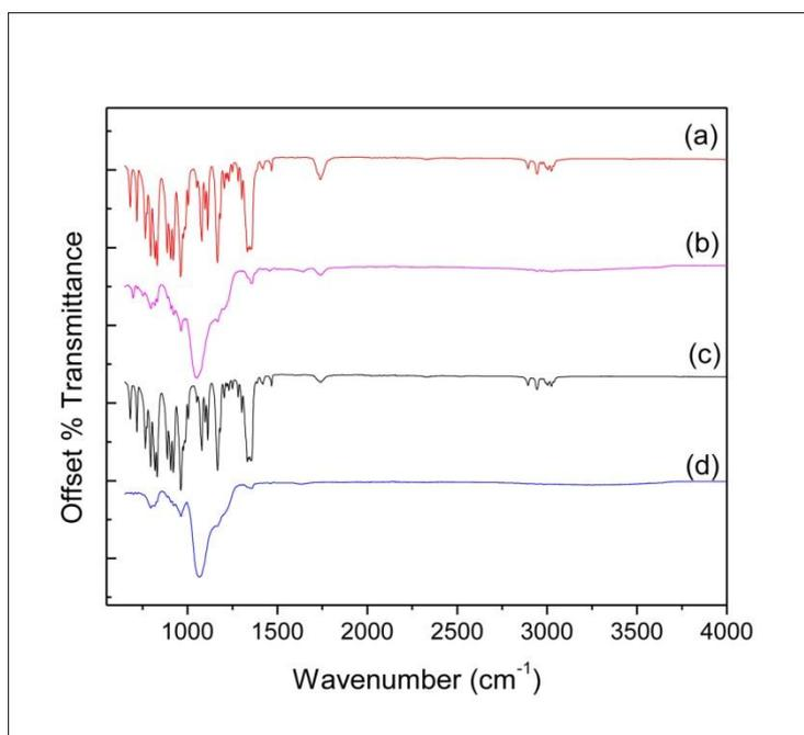
**Figure S7.** FTIR spectra of (a) OG, (b) OG-Si, (c) PFO-OG and (d) PFO-OG-Si.
