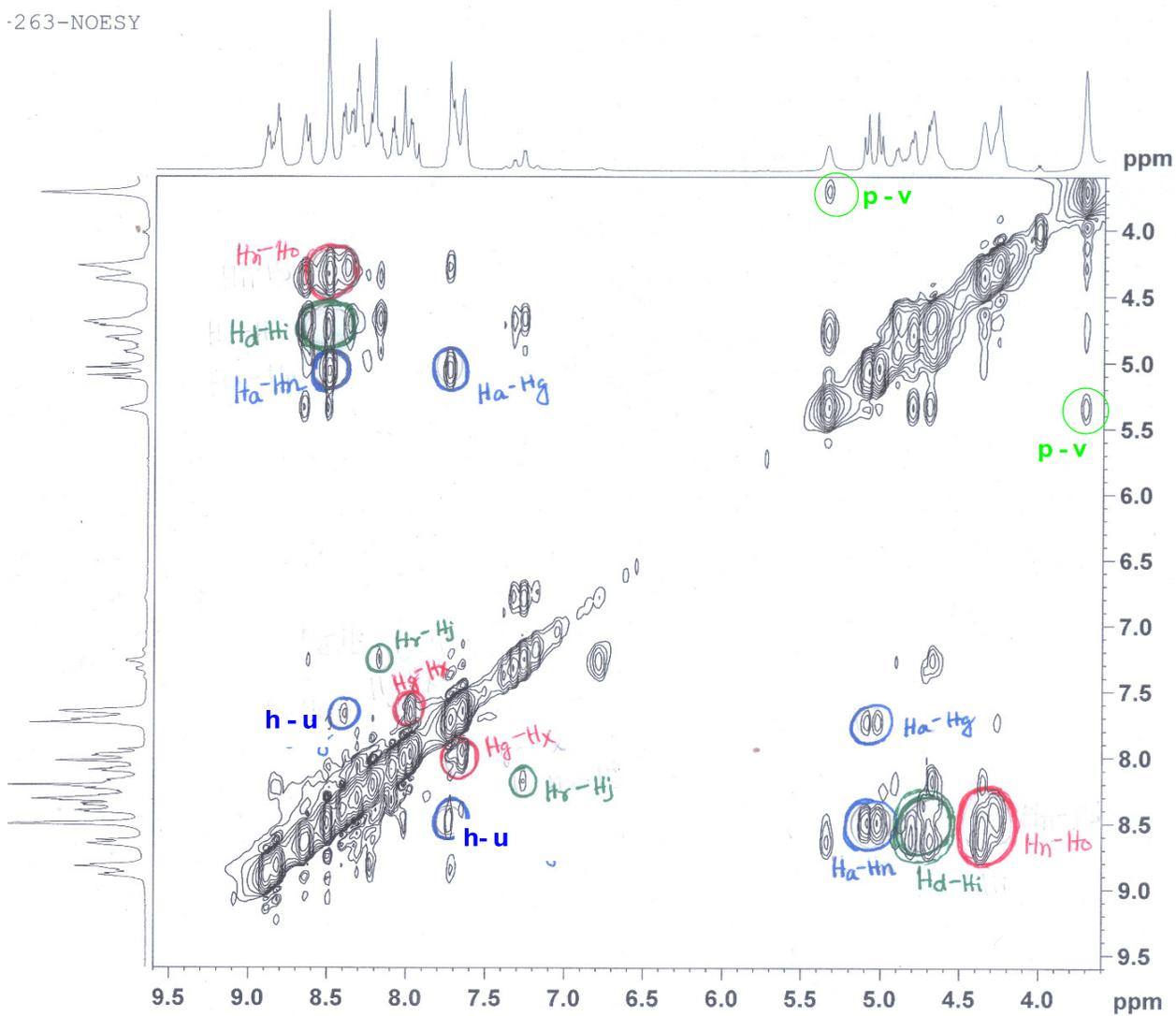
**Figure S22.** Expanded NOESY spectra of Pentapeptide 5 (BocNH-<sup>TPy</sup>Ala<sup>Do</sup>-Leu-<sup>Al</sup>TAA-Leu-<sup>TPhen</sup>Ala<sup>Do</sup>-CONMe(OMe)).
