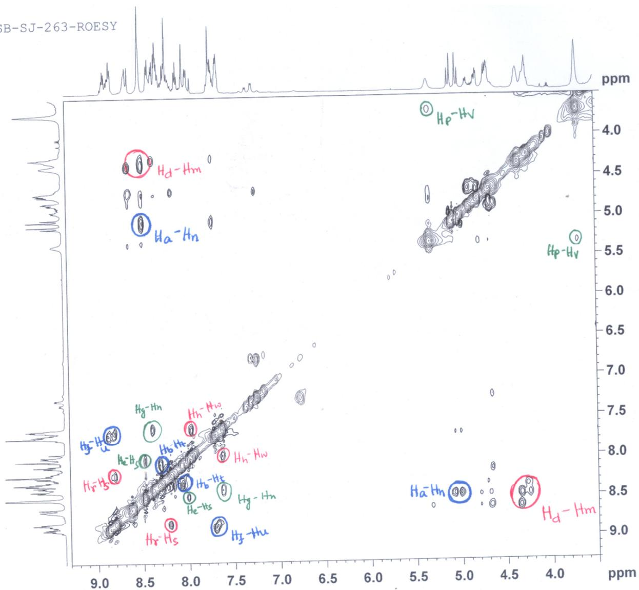
**Figure S23.** Expanded ROESY spectra of Pentapeptide 5 (BocNH-<sup>TPy</sup>Ala<sup>Do</sup>-Leu-<sup>Al</sup>TAA-Leu-<sup>TPhen</sup>Ala<sup>Do</sup>-CONMe(OMe)).
