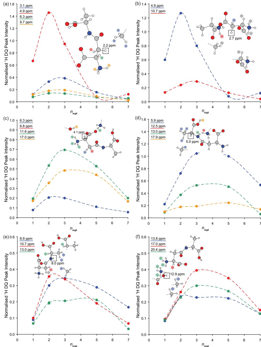
**Fig. S6** Experimental  $^1\text{H}$  DQ build-up curves for the (a)  $\text{CH}_2(\text{a})$ , (b)  $\text{CH}_2(\text{b})$ , (c)  $\text{CH}(\text{asp})$ , (d)  $\text{CH}(\text{ala})$ , (e)  $\text{NH}$ , (f)  $\text{OH}$  protons of the dipeptide  $\beta$ -AspAla.
