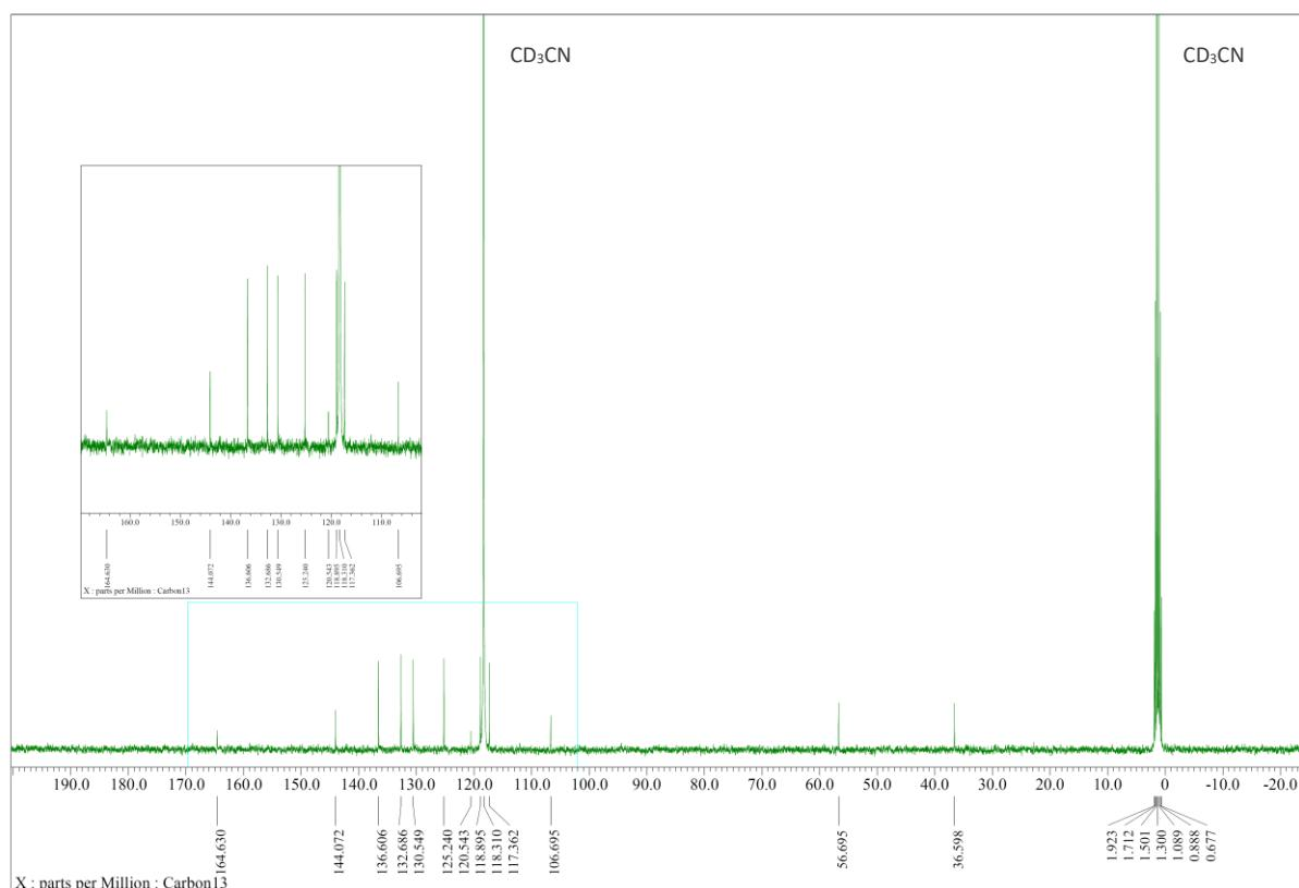
**Figure S16.**  $^{13}\text{C}$  NMR (100 MHz) spectrum of **2d** in  $\text{CD}_3\text{CN}$ .
