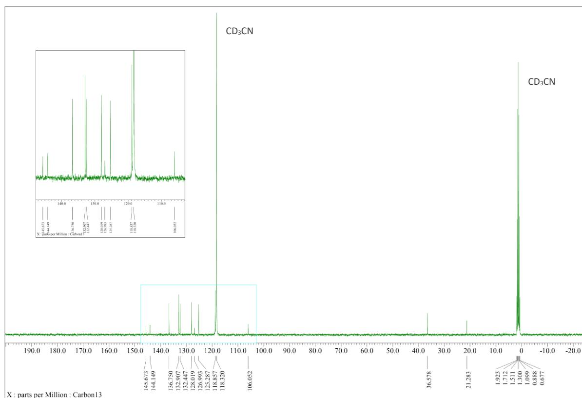
**Figure S18.**  $^{13}\text{C}$  NMR (100 MHz) spectrum of **2e** in  $\text{CD}_3\text{CN}$
