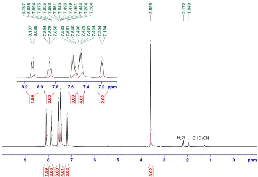
**Figure S5.**  $^1\text{H}$  NMR (400 MHz) spectrum of **2a** in  $\text{CD}_3\text{CN}$ .
