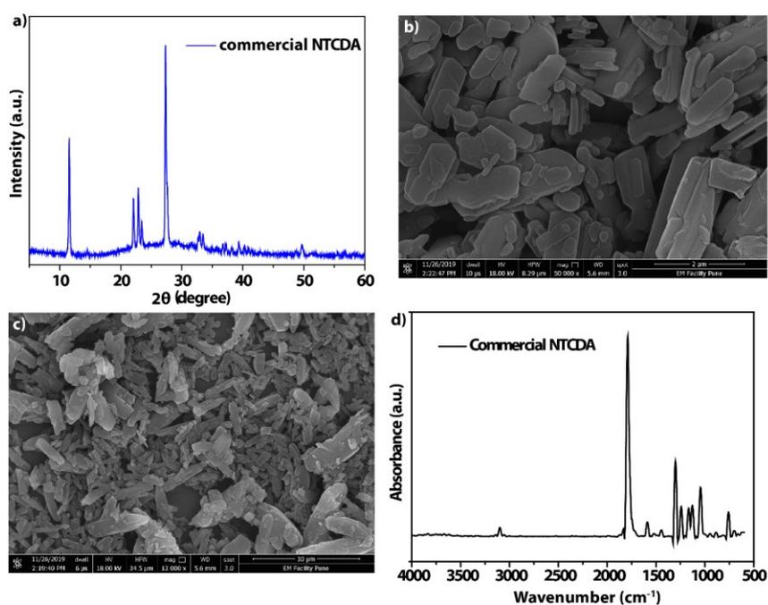
**Figure S1.** (a) XRD data and (b)-(c) FESEM images, (d) FTIR data of the commercial NTCDA.
