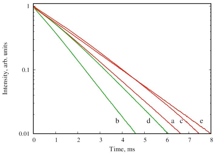
**Fig. S11.** Luminescence decays for  $\text{Zn}_2\text{Eu\_bpy}$  (a),  $\text{Zn}_2\text{Tb\_bpy}$  (b),  $\text{Zn}_2\text{Eu\_py}^{\text{II}}$  (c),  $\text{Zn}_2\text{Tb\_py}$  (d) and  $\text{Zn}_2\text{Eu\_lut}$  (e) at  $T = 300$  K.
