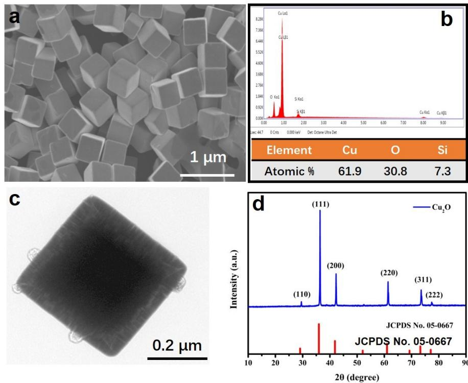
**Figure S1.** (a) SEM image (b) EDS (c) TEM image (d) XRD pattern of  $\text{Cu}_2\text{O}$ .
