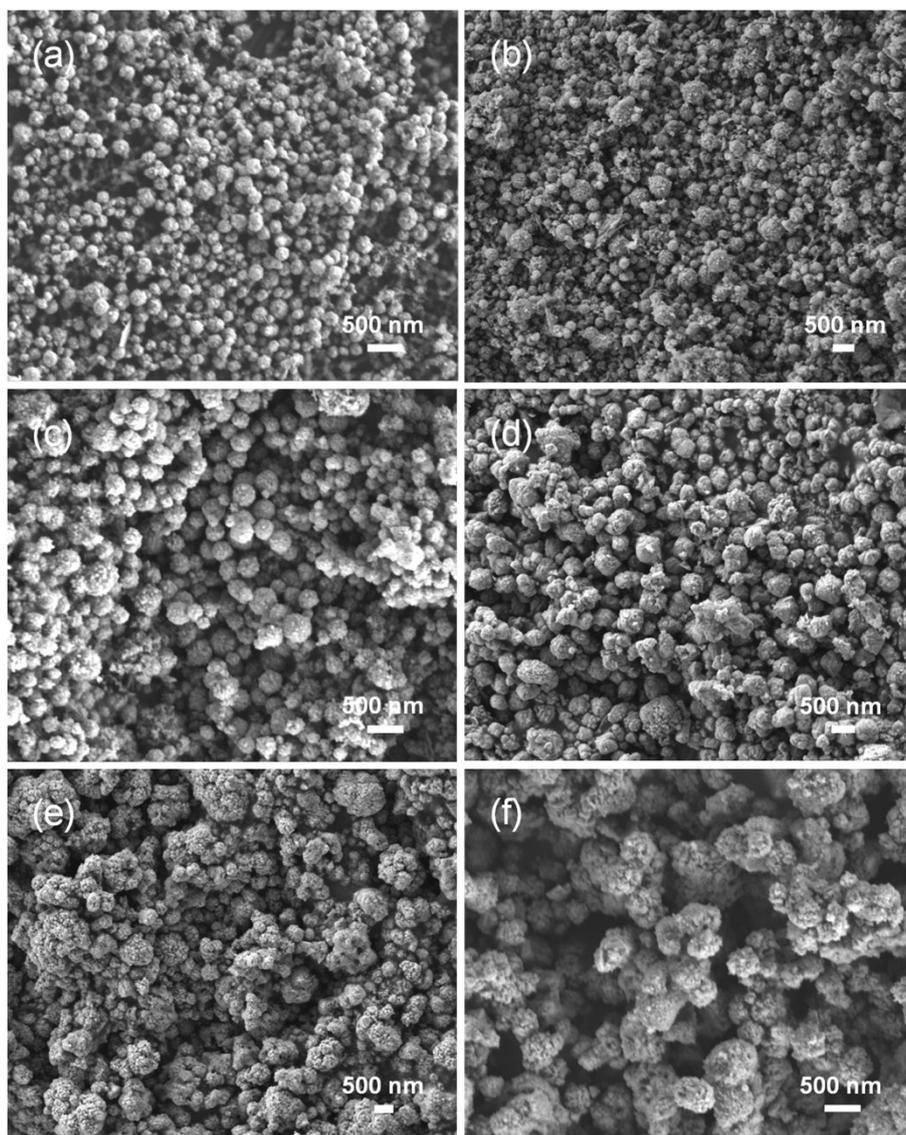
**Fig. S2** FE-SEM images of (a) CoSe, (b) Co<sub>0.8</sub>Fe<sub>0.2</sub>-Se, (c) Co<sub>0.6</sub>Fe<sub>0.4</sub>-Se, (d) Co<sub>0.4</sub>Fe<sub>0.6</sub>-Se, (e) Co<sub>0.2</sub>Fe<sub>0.8</sub>-Se and (f) FeSe<sub>2</sub>.
