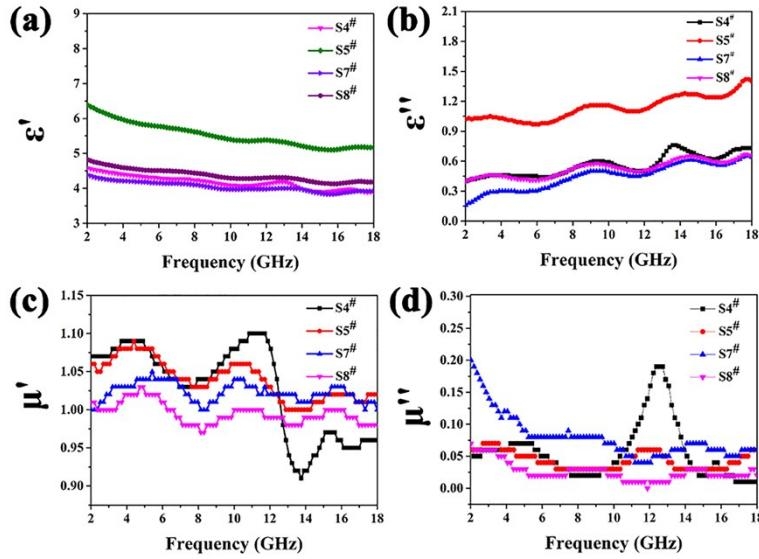
**Fig. S5.** EM parameters of the S4<sup>#</sup>, S5<sup>#</sup>, S7<sup>#</sup> and S8<sup>#</sup> in the frequency range of 2-18 GHz: (a)  $\epsilon'$ , (b)  $\mu'$ , (c)  $\epsilon''$ , (d)  $\mu''$ .
