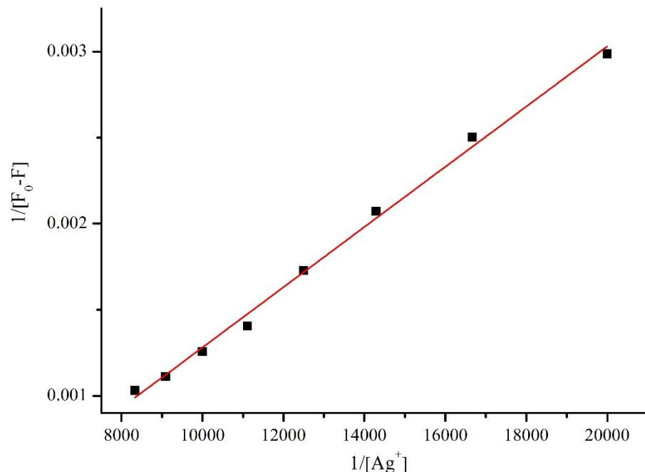
Fig. S4. The Benesi-Hilderbrand plot of probe DQT with  $\text{Ag}^+$ . Linear Equation:  $Y=1.75\times10^{-7}\times X-4.69\times10^{-4}$ ,  $R^2=0.9953$ ,  $K_a=2.68\times10^3 \text{ M}^{-1}$ .
