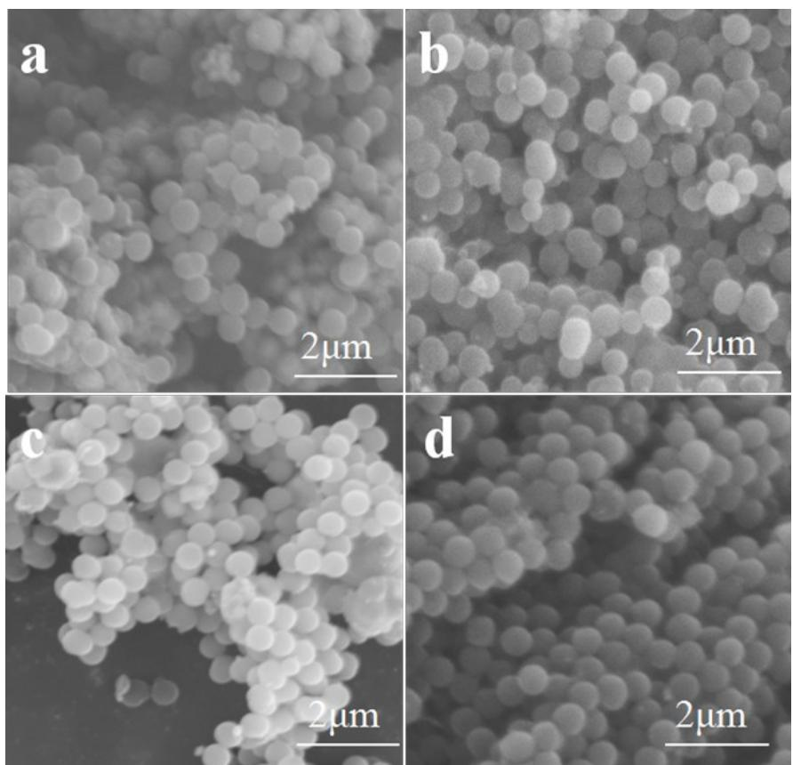
Figure S1 SEM images of NHCSSs : (a) S1, (b) S2 , (c) S3 and (d) S4.
