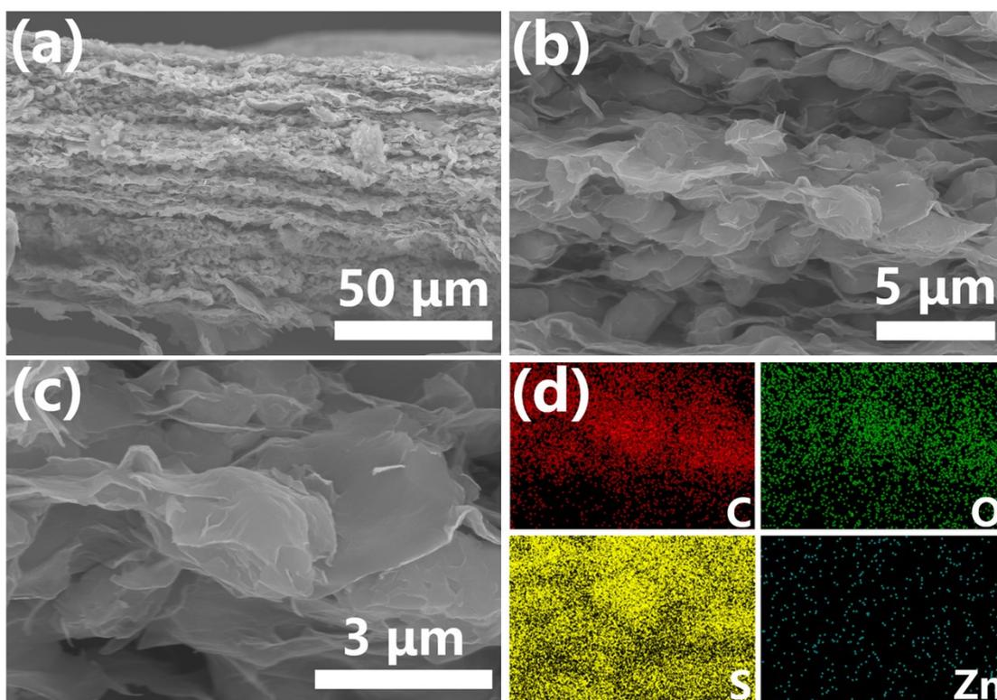
**Figure S11.** (a-c) SEM image and (d) EDS mapping of rGO@ZnO QDs/S-G
