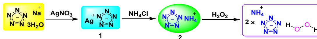
**Scheme S1.** Synthesis of  $\text{NH}_4\text{N}_5 \cdot \frac{1}{2}\text{H}_2\text{O}_2$ .
