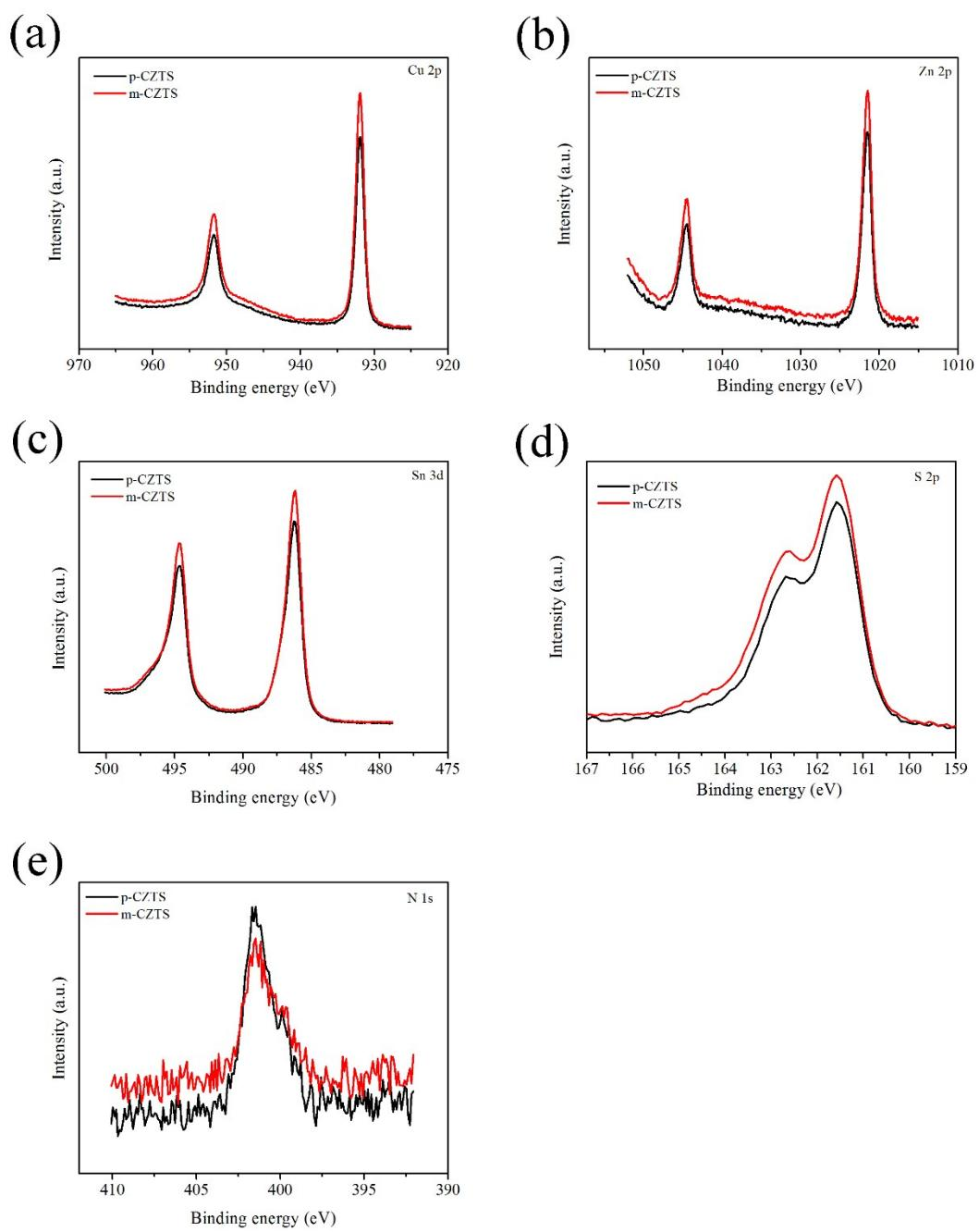
Fig. S1. High resolution core XPS spectra of (a) Cu 2p, (b) Zn 2p, (c) Sn 3d, (d) S 2p, and (d) N 1s for p-CZTS and m-CZTS nanoparticles.
