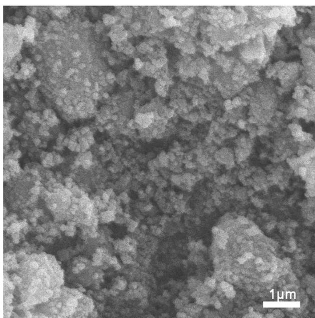
**Fig. S7.** SEM of UIO@Ca-Pt NPs
