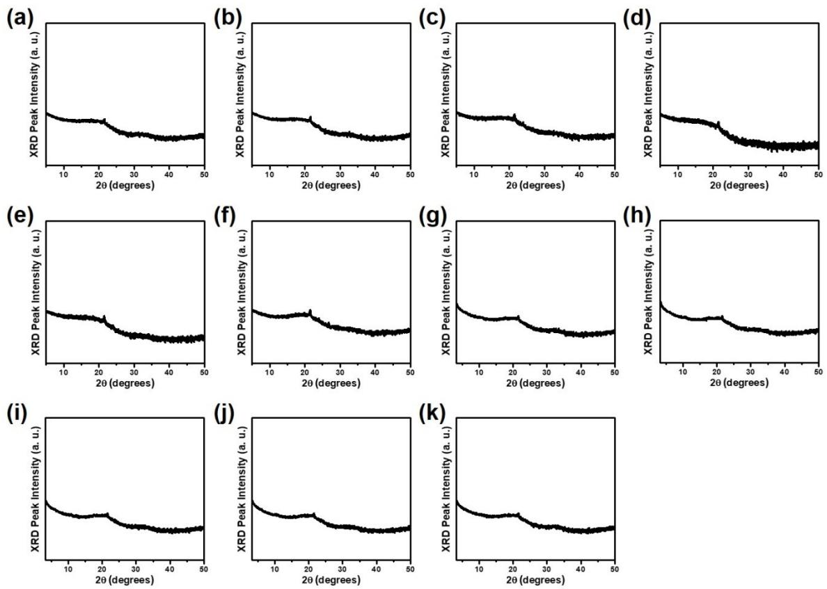
**Fig. S1**  $\theta$ - $2\theta$  XRD scans of thin films of (a)  $a$ -IGZO, (b)  $a$ -IGZO ( $390\text{ }^\circ\text{C}$ ), (c)  $a$ -IGZO/ $C_8$  PA, (d)  $a$ -IGZO/ $C_{12}$  PA, (e)  $a$ -IGZO/ $C_{18}$  PA, (f)  $a$ -IGZO ( $390\text{ }^\circ\text{C}$ )/ $C_{12}$  PA, (g)  $a$ -IGZO/ $C_{60}$ , (h)  $a$ -IGZO/ $C_8$  PA/ $C_{60}$ , (i)  $a$ -IGZO/ $C_{12}$  PA/ $C_{60}$ , (j)  $a$ -IGZO/ $C_{18}$  PA/ $C_{60}$ , and (k)  $a$ -IGZO ( $390\text{ }^\circ\text{C}$ )/ $C_{12}$  PA/ $C_{60}$ .
