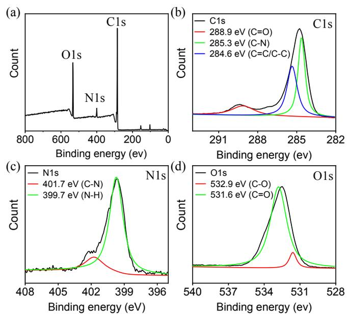
**Fig. S5** XPS spectra of DBP-CDs. (a) Survey profile, (b) C1s, (c) N1s and (d) O1s.
