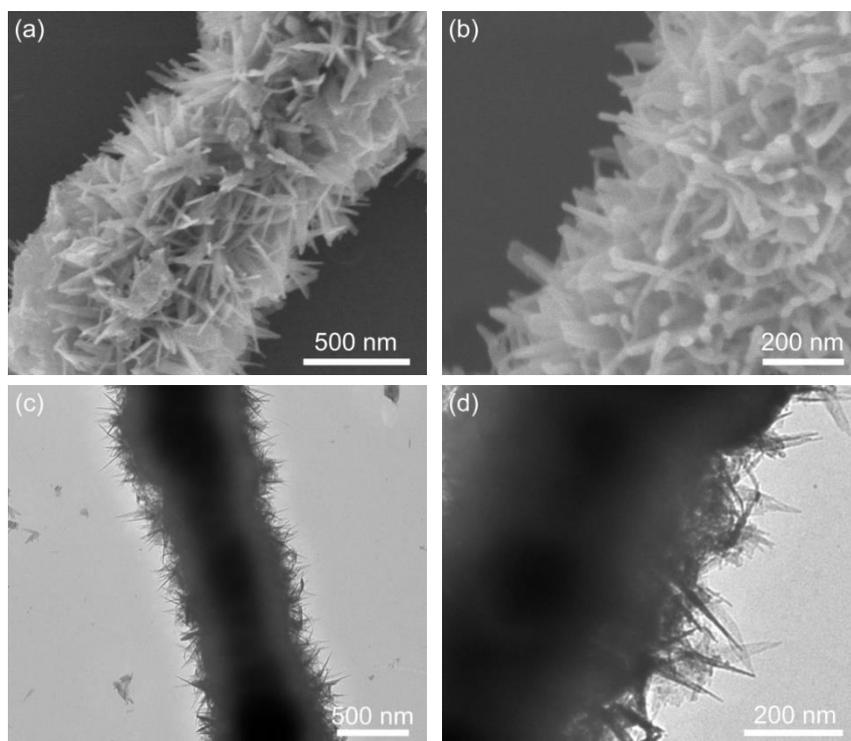
**Fig. S2** (a,b) SEM images of the  $\text{Fe}_3\text{O}_4@\text{SiO}_2@\text{FeOOH}$ . (c,d) TEM images of the  $\text{Fe}_3\text{O}_4@\text{SiO}_2@\text{FeOOH}$ .
