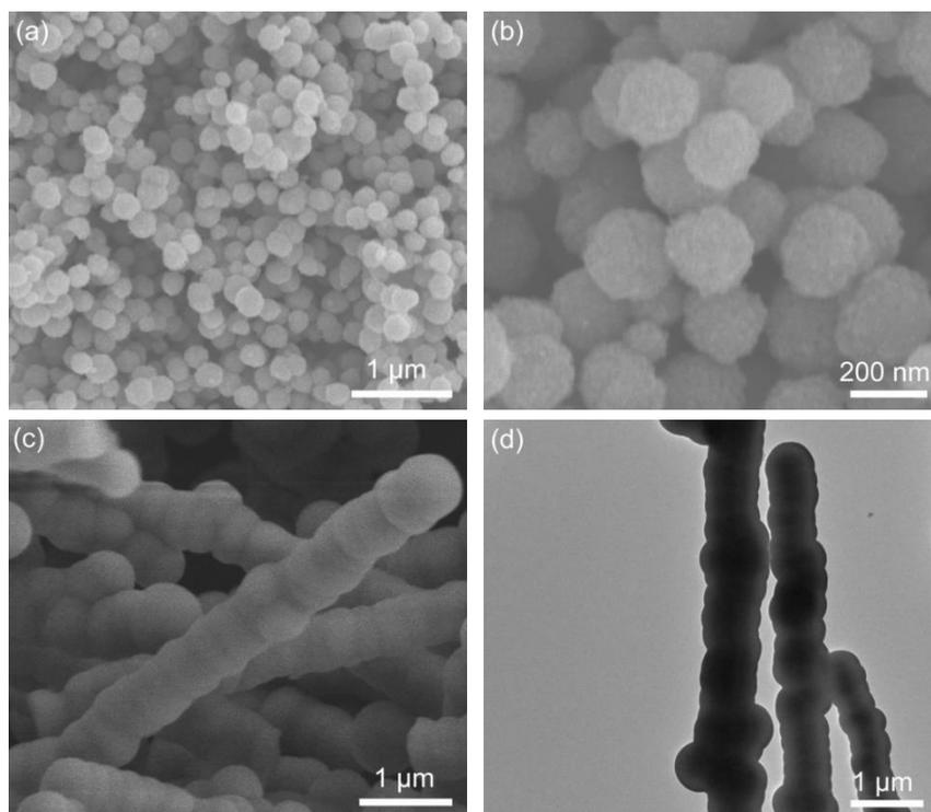
**Fig. S1** SEM images of the (a,b)  $\text{Fe}_3\text{O}_4$  nanospheres, (c)  $\text{Fe}_3\text{O}_4@\text{SiO}_2$ . (d) TEM images of  $\text{Fe}_3\text{O}_4@\text{SiO}_2$ .
