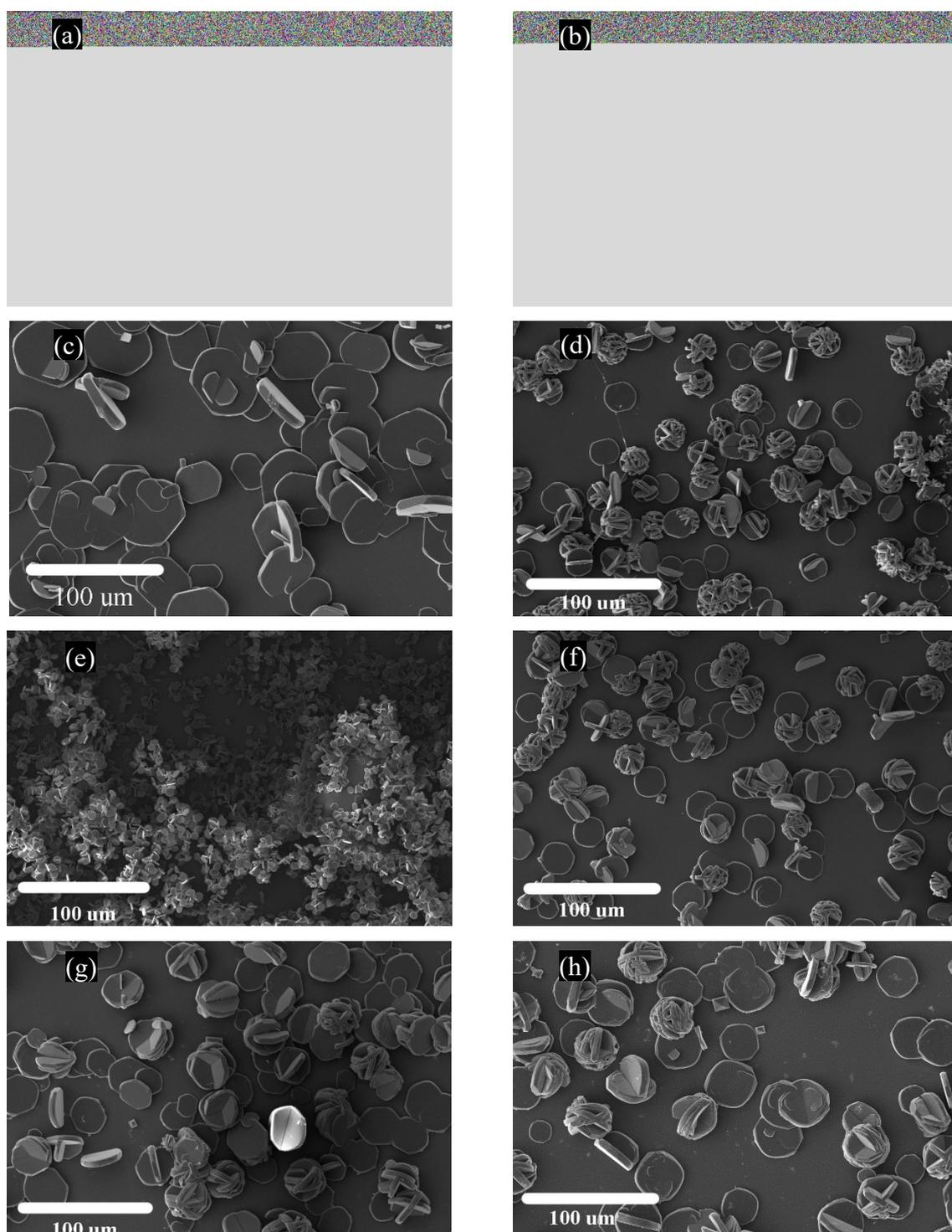
Figure S2. SEM micrographs of CaOx in (a) pure SUM; (b) SUM+Zn<sup>2+</sup> (c) Asp, 4 mM; (d) Asp+Zn<sup>2+</sup>; (e) Pro, 4 mM; (f) Pro+Zn<sup>2+</sup>; (g) Lys, 4 mM; (h) Lys+Zn<sup>2+</sup> 1mM. Scale bar 100 μm
