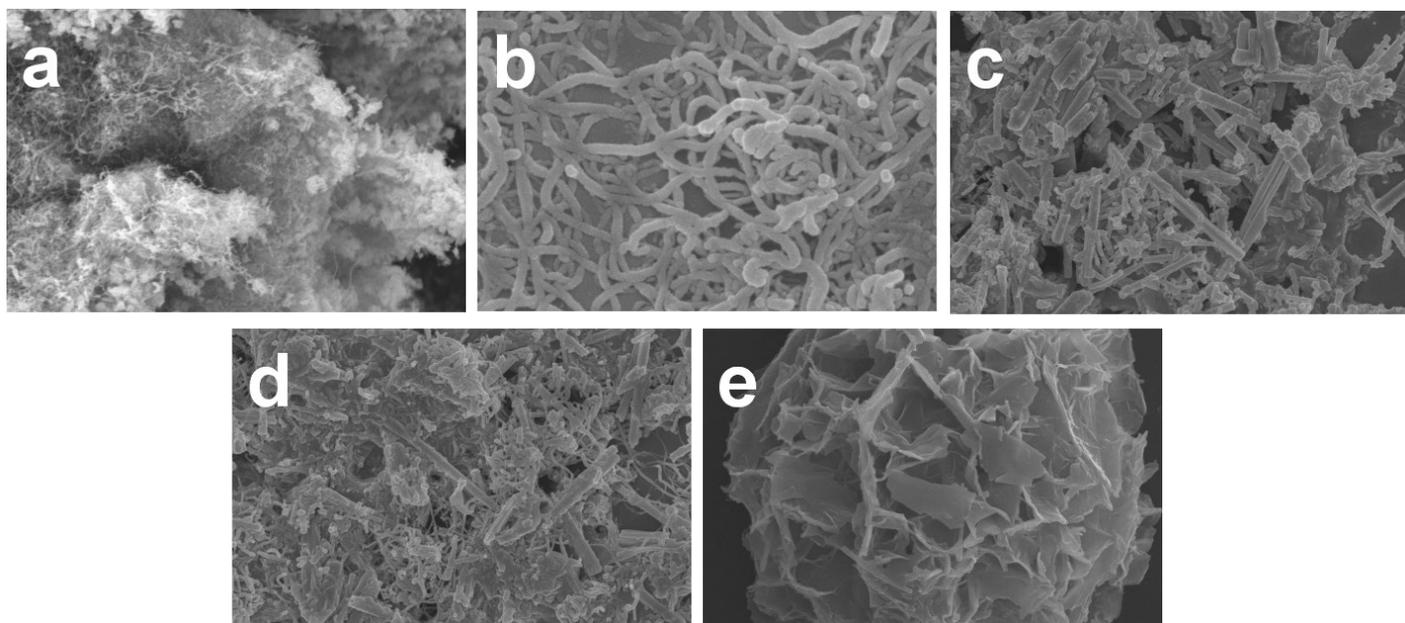
**Fig. S2** SEM images of (a) CNTs, (b) aCNTs, (c) Co<sub>9</sub>S<sub>8</sub>-aCNT (low), (d) Co<sub>9</sub>S<sub>8</sub>-aCNT (high), (e) NiCoLDH.
